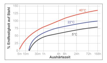
Aushärtegeschwindigkeit in Abhängigkeit vom Aktivator Das folgende Diagramm zeigt die zeitliche Entwicklung der Scherfestigkeit bei Wellen und Naben aus Edelstahl unter Verwendung von Aktivator 7471 und 7649. Geprüft gemäß ISO 10123.
