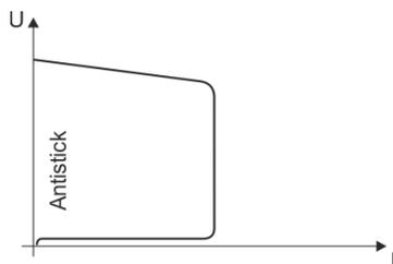
**Antistick evita o recozimento do eléctrodo .**
