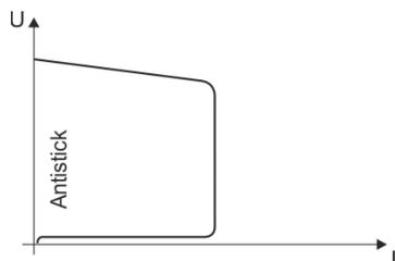
**L'anti-collage prévient le recuit de l'électrode.**
