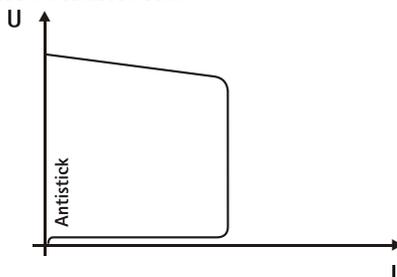
**Il dispositivo anti-incollamento impedisce la bruciatura dell'elettrodo.**
