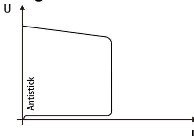
**Système anti-collage pour empêcher un recuit de l'électrode.**
