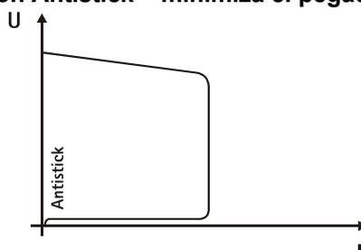
**Anti-stick evita el sobrecalentamiento del electrodo.**
