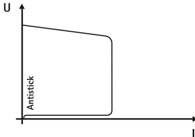
**Anti-stick evita el sobrecalentamiento del electrodo.**
