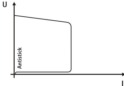
**Il dispositivo anti-incollamento impedisce la bruciatura dell'elettrodo.**
