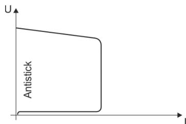
**Antiadherente (antistick) impide el destemplado del electrodo.**
