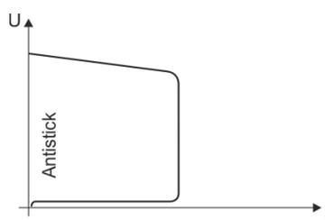
**Antistick evita o recozimento do eléctrodo .**
