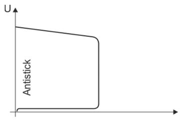
**L'anti-collage prévient le recuit de l'électrode.**
