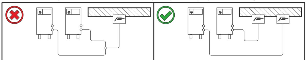
Dérouler entièrement les lignes de courant de soudage, le faisceau de torche de soudage et le faisceau intermédiaire. Éviter les boucles !
