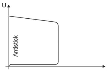
**L'anti-collage prévient le recuit de l'électrode.**
