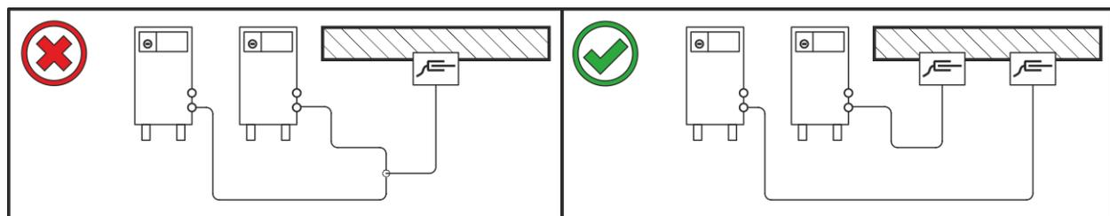
**Schweißstromleitungen, Schweißbrenner- und Zwischenschlauchpakete vollständig abrollen. Schlaufen vermeiden!**
