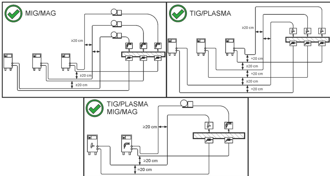
**Für jedes Schweißgerät eine eigene Werkstückleitung zum Werkstück verwenden!**
